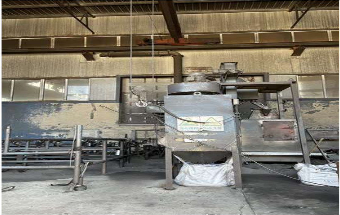
图 3-3 抛丸工序布袋除尘
