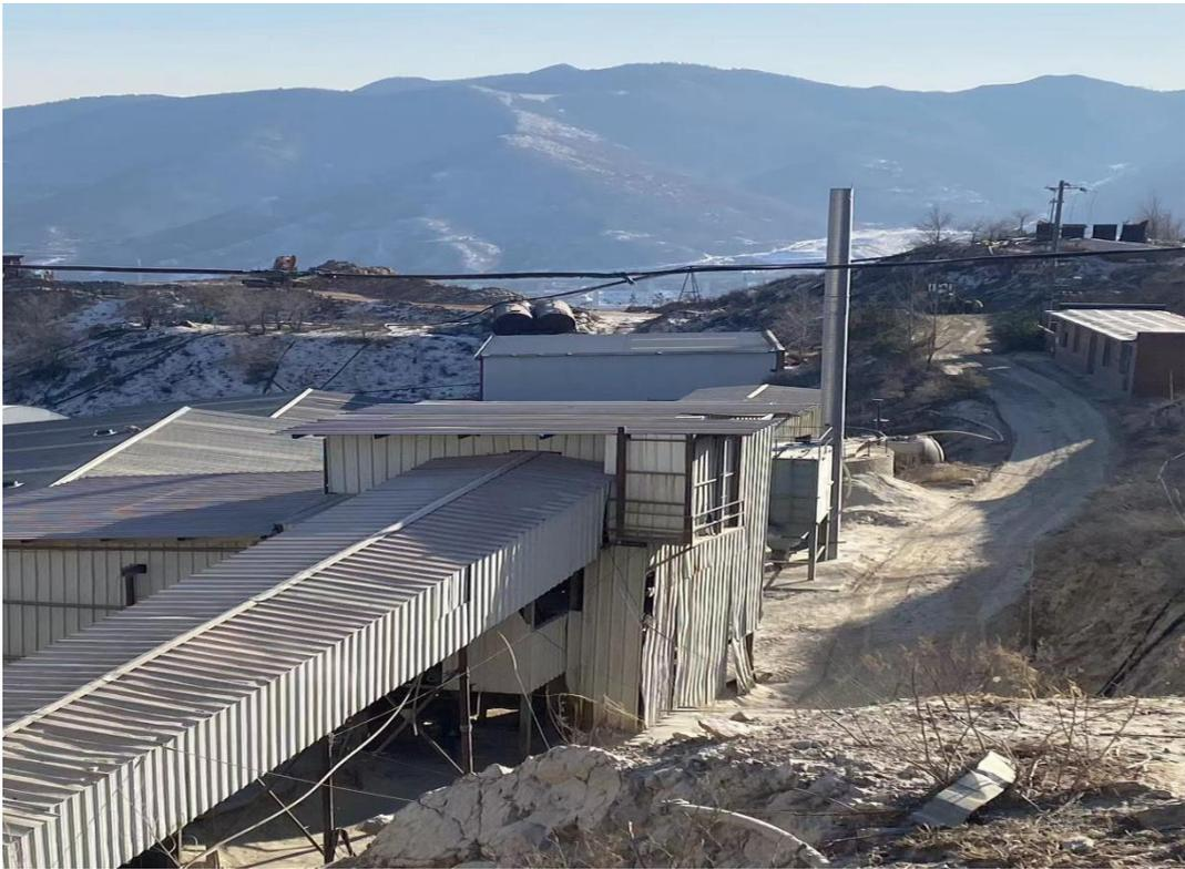
图 3.2-5 破碎筛分布袋除尘器及排气筒（2）
